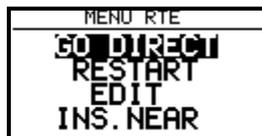
**INS. NEAR** ermöglicht ein Waypoint direkt aus NEAR AIRPORT einzufügen (vor der Nase) und damit die Aufgabe sehr einfach zu modifizieren. Nach diesem Vorgang steht die Navigation an diesen Waypoint sofort bereit.
