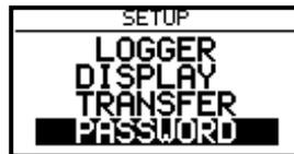
Mit dem UP / DOWN- Selektor werden die verschiedenen Menü-Positionen von **LOGGER** bis **PASSWORD** angewählt.
