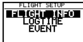
Unter "**FLIGHT INFO**" sind alle wichtigen Daten wie Pilot, Flugzeug und Kennzeichen gespeichert. Nach ENTER unter FLIGHT INFO sind alle diesen Einstellungen möglich. Selbstverständlich sind alle diesen Einstellungen auch mit einem PC und dem LXe Programm möglich. Die Eingabe erfolgt über ENTER, UP/DOWN Selektor und ESC.
