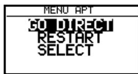
Nach Enter auf GO DIRECT springt das Gerät wieder in die Navigation zurück (BRG=DTK und CDI in der Mitte) **Restart** ist auf die s.g. einfache Aufgabe bezogen, nach Restart fängt die Flugstatistik wieder von neuem an. Wird eine reguläre Aufgabe (RTE) gestartet, wird diese Zeile verschwinden.
